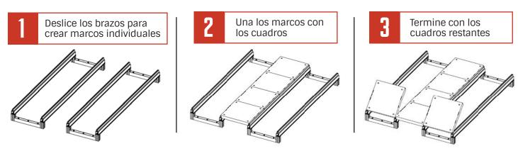
Continúe el proceso hasta lograr el ancho deseado. Utilice los conectores FOUNDATION para unir las secciones de extremo a extremo hasta alcanzar el largo deseado.
