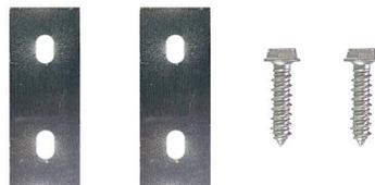
Zur Verwendung mit 10 cm hohen FOUNDATION Plattformssets sichern diese korrosionsbeständigen Ankersätze die Plattform auf Betonböden. Verwenden Sie nach der Montage der 10-cm-Plattform 1 Set für jede Balkenreihe. Jedes Kit enthält bis zu 2 Platten und 2 Betonschrauben.
