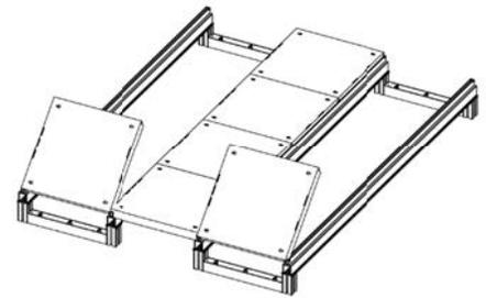
Fahren Sie mit dem Prozess bis zur gewünschten Breite fort. Verwenden Sie FOUNDATION-Verbinder, um die Abschnitte auf die gewünschte Länge zu verbinden.
